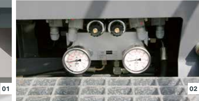
01 Die Bohlenlängsbleche werden standardmäßig mit großflächig wirkenden Heizelementen beheizt. 02 In Schwimmstellung der Bohle kann zusätzlich die Bohlenentlastung aktiviert werden.
