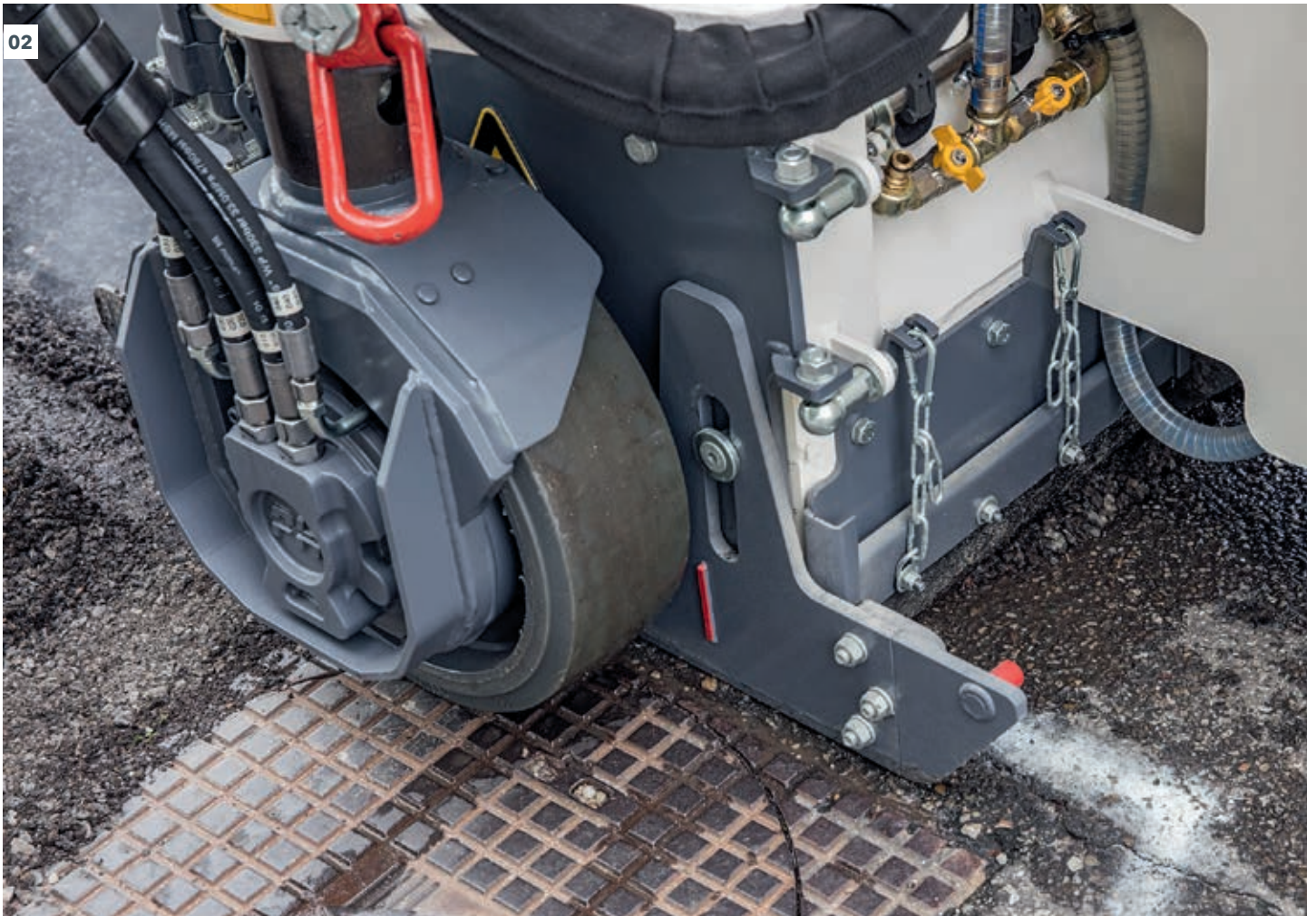
01 - 02 Der elektronisch geregelte Fahrtrieb ermöglicht exaktes Fräsen – wie z. B. an Straßeneinbauten.
