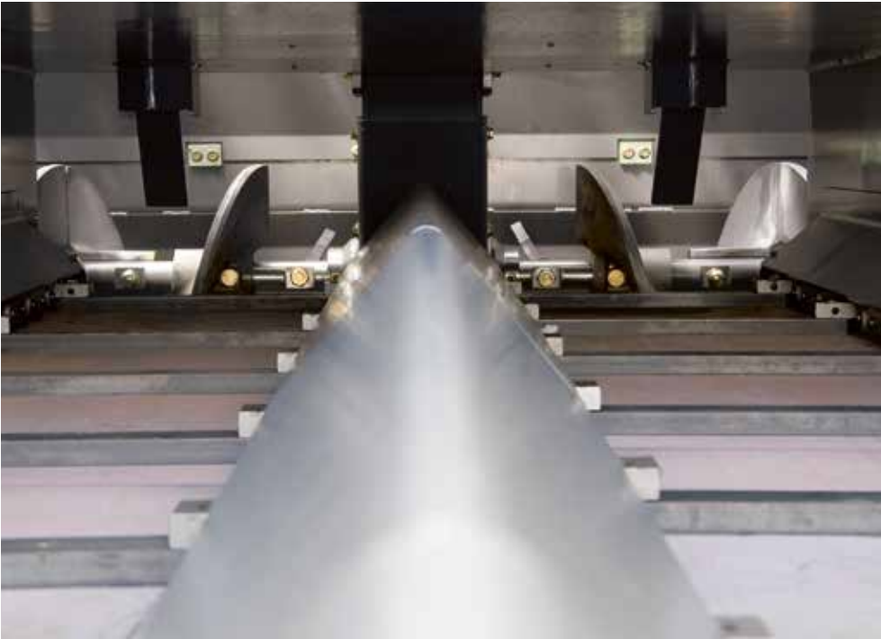
Das Kratzerband kann mit nur einem Tastendruck reversiert werden. Der Rücktransport des Mischgutes stoppt automatisch. Ebenso schnell kann das Kratzerband in die Leerlauffunktion gebracht werden.
