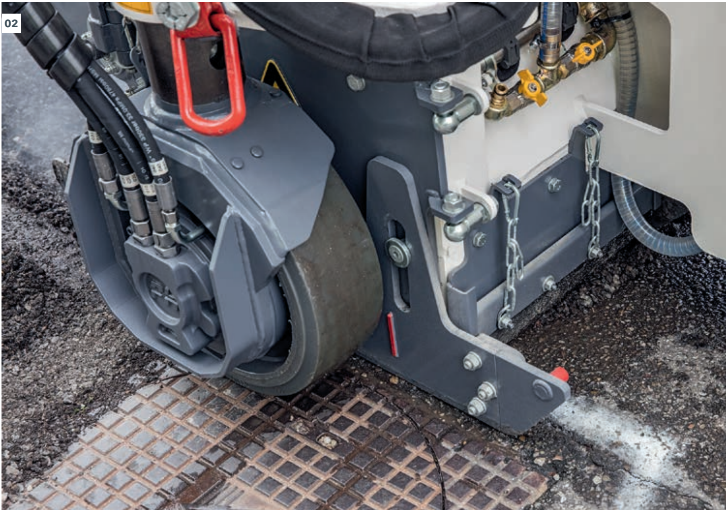
01 - 02 La régulation électronique de l'entraînement de traction permet un fraisage de précision - p. ex. le long d'éléments d'infrastructure routière.
