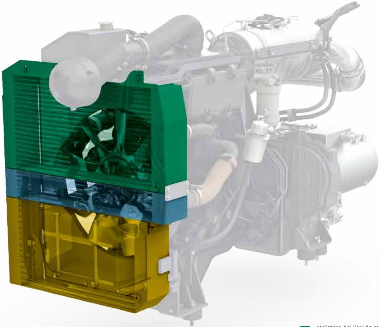
■ = radiatore del liquido refrigerante ■ = intercooler ■ = radiatore dell'olio idraulico
