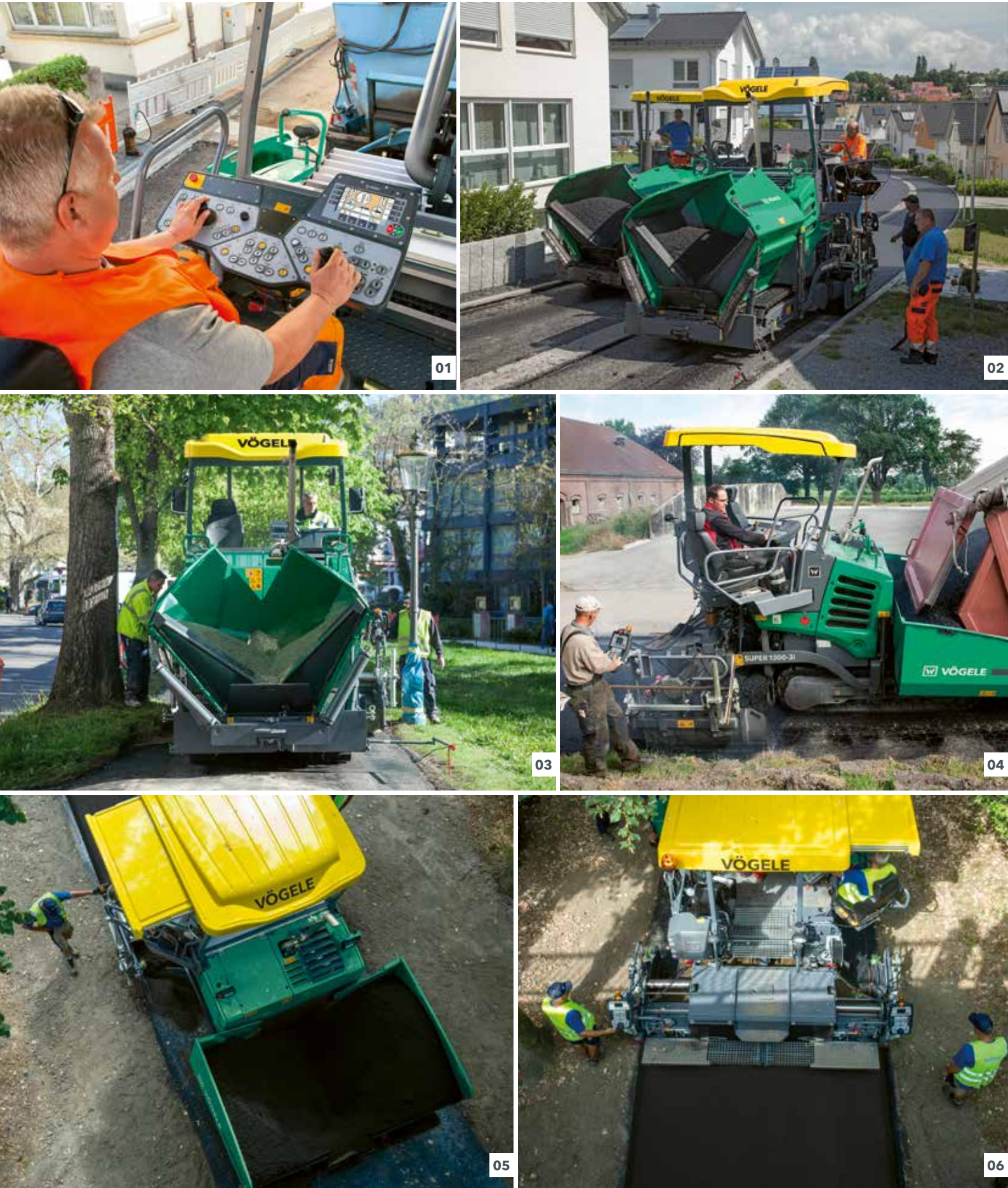
01 Système de conduite ErgoPlus 3 avec de nombreuses fonctions automatiques et confortables 02 Finisseur sur chenilles couvrant un large champ d'applications. 03 La conception mince de la machine et la longueur totale compacte facilitent énormément le travail et les manœuvres sur les chantiers exigus.
