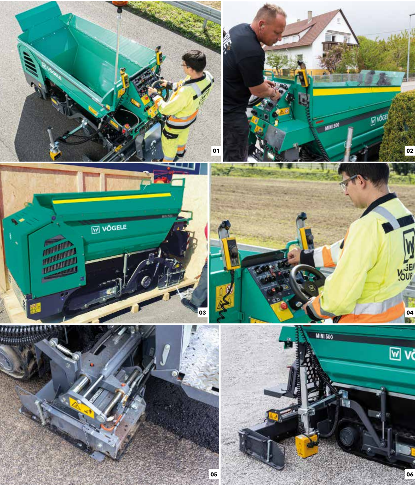
01 Trémie réceptrice d'une capacité allant jusqu'à 1,2 tonne et grande ouverture de trémie pour une alimentation optimale. 02 Idéal pour la pose d'asphalte sur des chemins étroits. 03 Facile à transporter grâce à ses dimensions compactes, à son faible poids et aux parois de la trémie et aux postes de commande inclinables.
