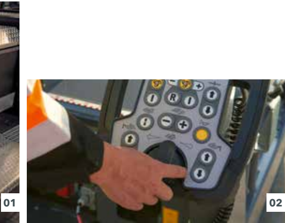
01 Das kontrastreiche Farbdisplay sorgt für eine brillante Ablesbarkeit auch bei schlechten Lichtverhältnissen. Darüber hinaus bietet die nach unten gerichtete LED-Hochleistungsbeleuchtung eine optimale Sicht. 02 Die Breitenverstellung der Einbaubohle wird mittels des griffigen SmartWheels vorgenommen.
