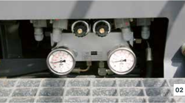
01 Les tôles lisseuses de la table sont toujours chauffées par des éléments de chauffe à action couvrante. 02 Lorsque la table est en position flottante, le soutènement de la table peut en plus être activé.
